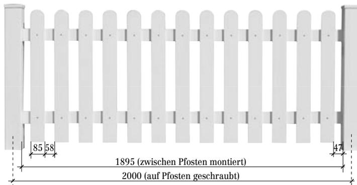
Die Zaunelemente wirken optisch leicht, weisen jedoch eine gute Stabilität und Festigkeit auf. Die Kunststofftraversen sind verstärkt. Bei Bedarf sind auch feuer-
